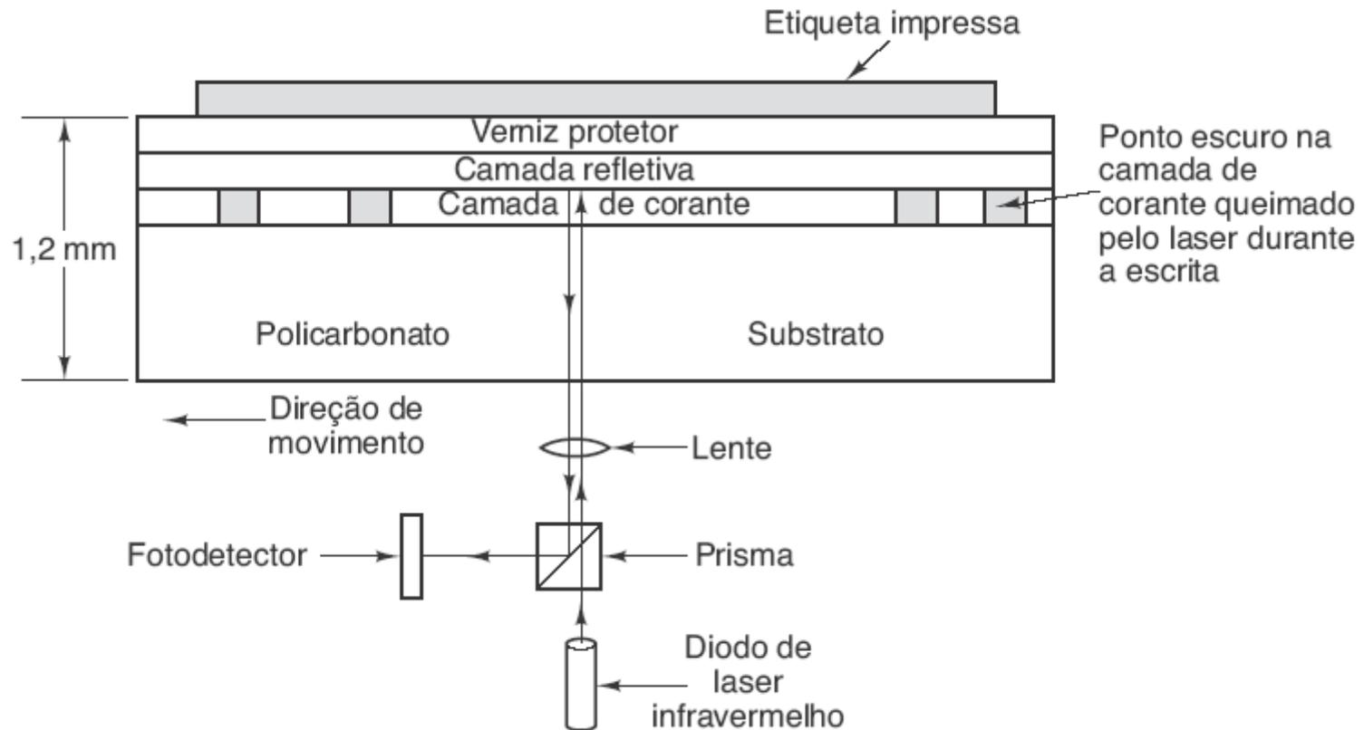
Seção transversal de um disco CD-R e laser (não está em escala). Um CD-ROM tem uma estrutura semelhante, exceto por não ter a camada de corante e por ter uma camada de alumínio com depressões ao invés da camada refletiva.
