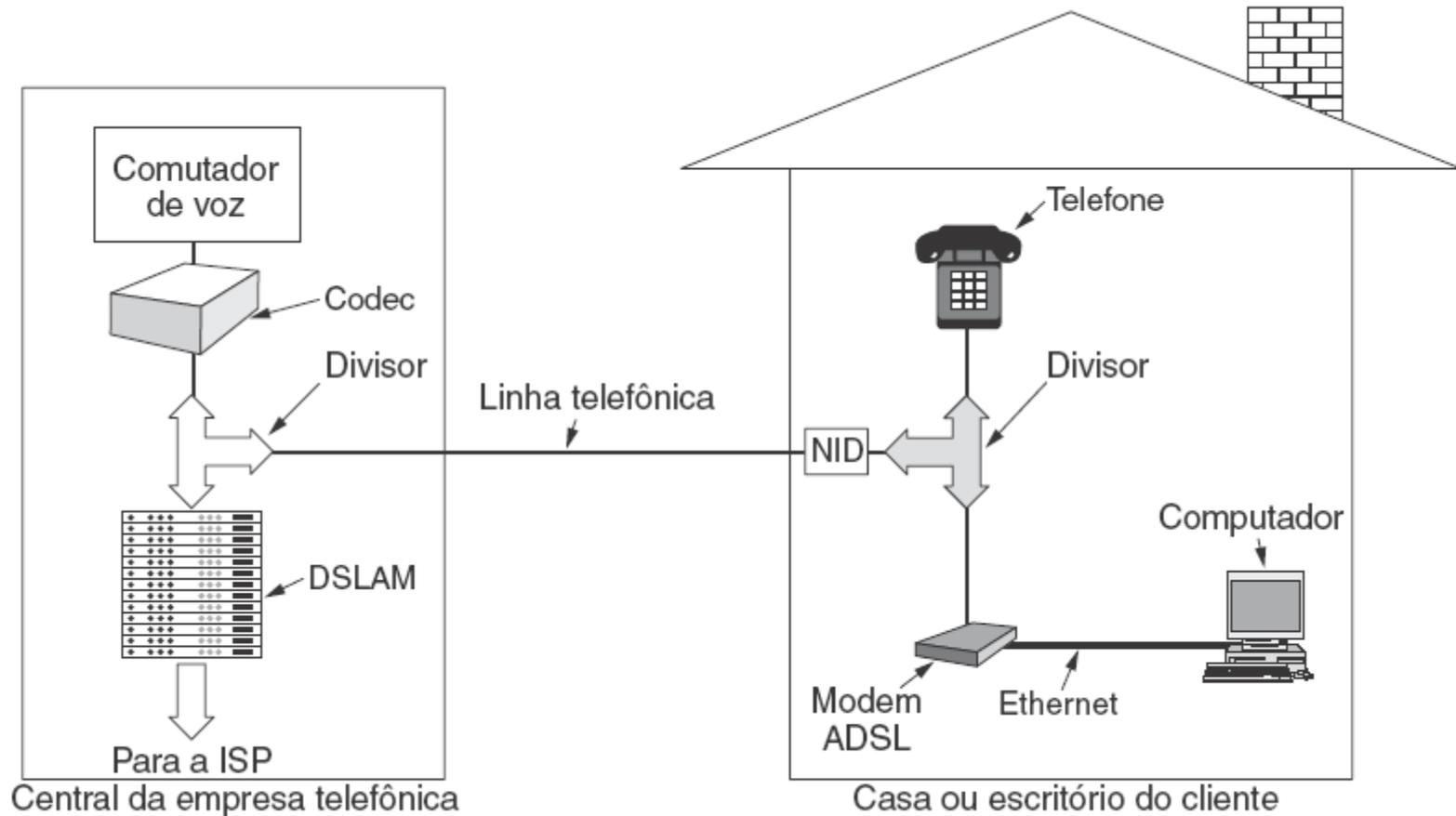
Configuração típica de equipamento ADSL.
