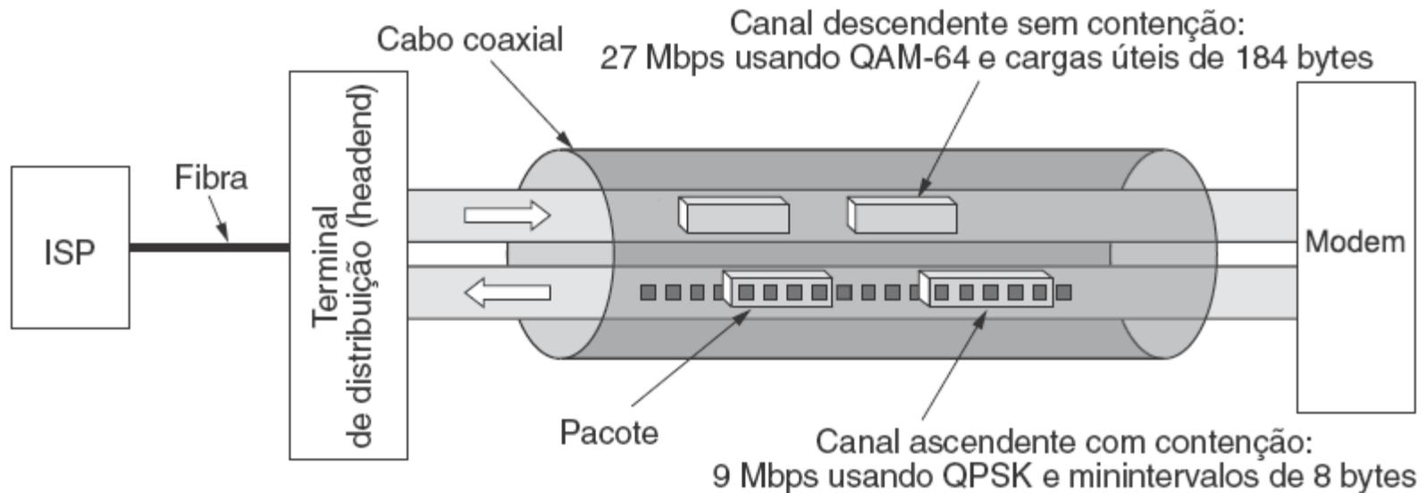
Detalhes típicos dos canais ascendentes e descendentes na América do Norte. QAM-64 (Modulação de amplitude em quadratura) permite 6 bits/Hz, mas funciona somente em altas frequências. QPSK (Modulação por chaveamento de fase em quadratura) funciona em baixas frequências, mas permite apenas 2 bits/Hz.
