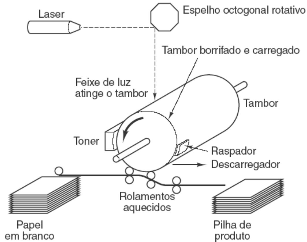
Funcionamento de uma impressora a laser.
