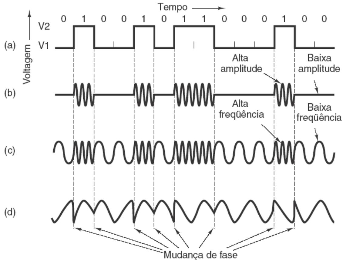
Transmissão, bit a bit, do número binário 01001010000100 por uma linha telefônica. (a) Sinal de dois níveis. (b) Modulação de amplitude. (c) Modulação de frequência. (d) Modulação de fase.
