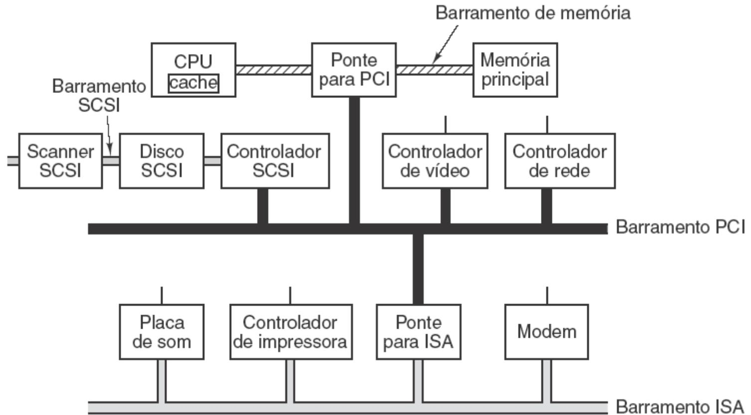
PC moderno com um barramento PCI e um barramento ISA.
