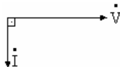
figura 1.4 – Diagrama fasorial circuito L.
