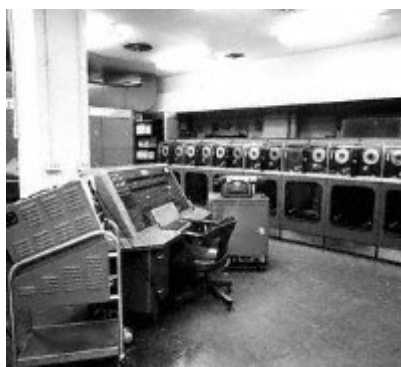
Figura 1.4: Sistema Univac, 1951 (processamento em lote - batch )
