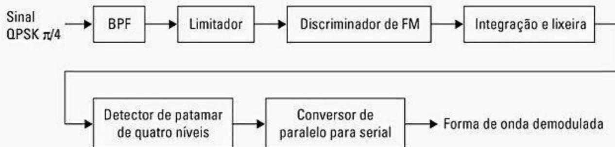
Figura 6.35 Detector discriminador de FM para a demodulação DQPSK π/4.
