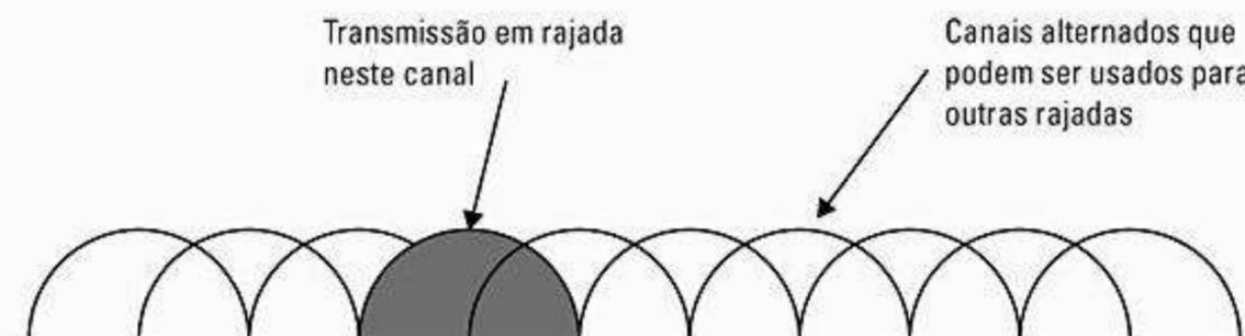
**Figura 9.7** Espectro de frequência de um sistema FH/DS híbrido.
