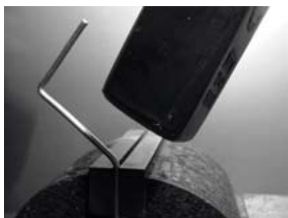
Figura 4.16: Dobre o fio na forma de um 'Z'.
