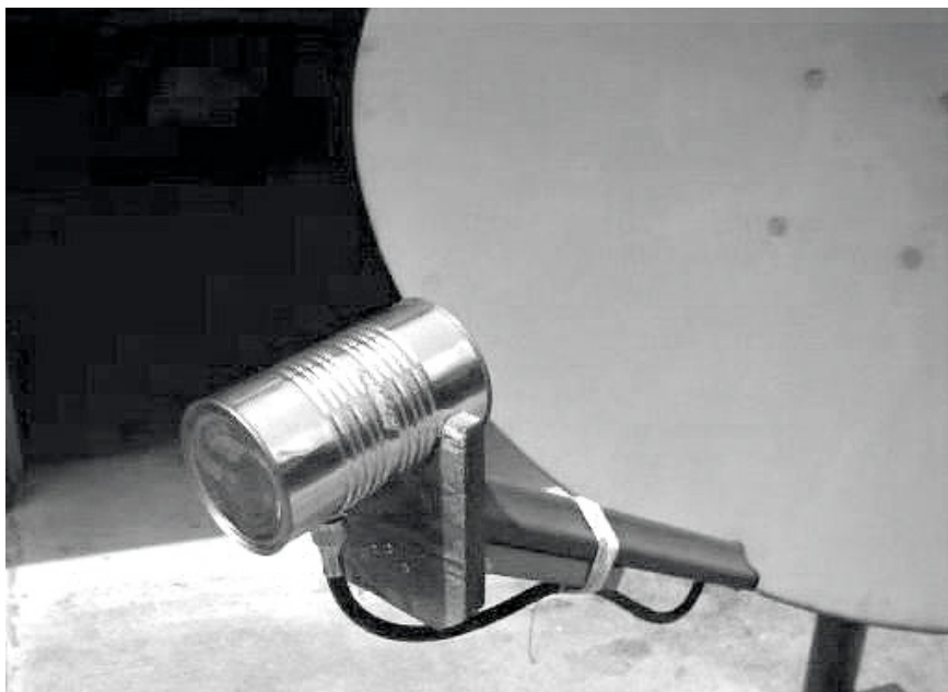
Figura 4.10: Corneta de alimentação feita com uma lata de comida.
