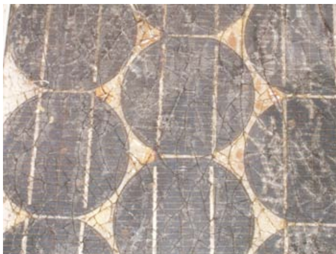
Figura 7.6: O efeito da água e corrosão em um painel solar.
