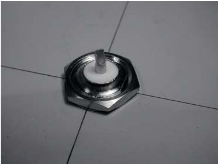
Figura 4.24: Firme bem o conector N à placa.
