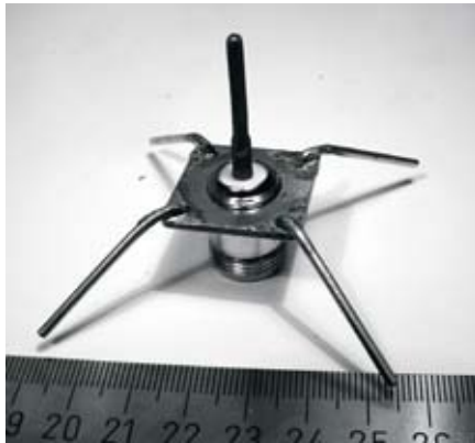
Figura 4.8: Antena plano-terra de \frac{1}{4} de comprimento de onda.
