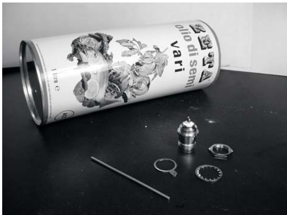
Figura 4.33: Componentes necessários para a antena de lata.
