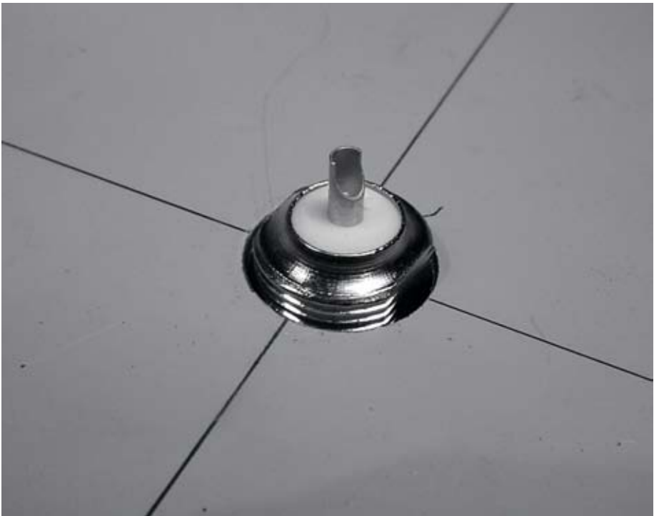
Figura 4.22: O furo deve servir para o encaixe perfeito do conector N.
