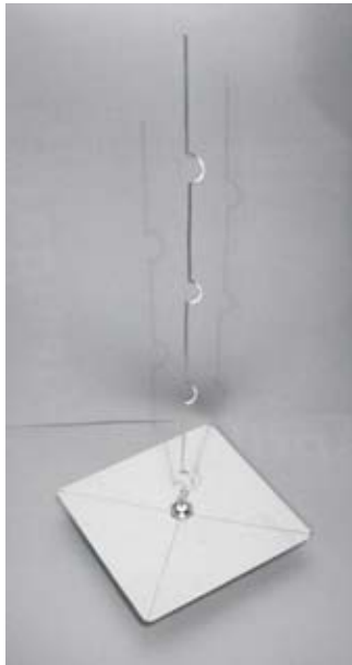
Figura 4.29: A antena finalizada deve ter 42,5 cm da placa ao final do fio.
