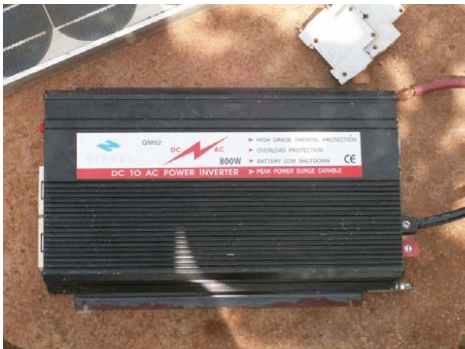
Figura 7.4: Um conversor DC/AC (inversor) de 800 Watts.
