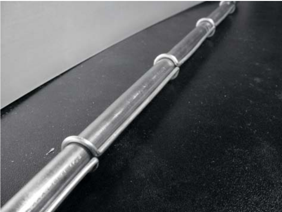
Figura 4.20: Inserir um cano entre as espiras pode ajudar a endireitar o fio.
