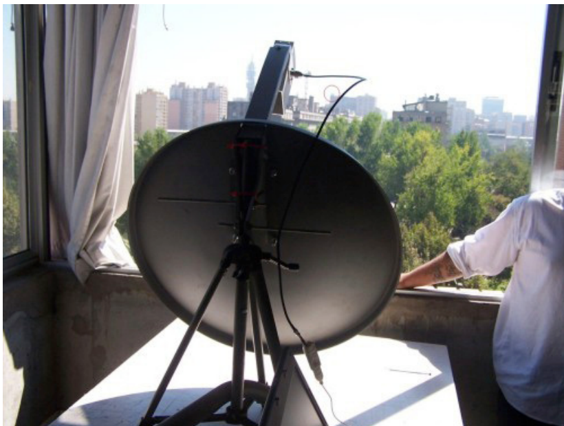
Figura 11.17: Estação wireless e antena parabólica usadas para a transmissão do evento Santiago-2006 FLISOL via streaming de vídeo.
