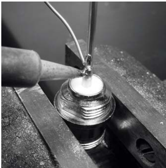
Figura 4.38: Solde o fio ao copo dourado no conector N.
