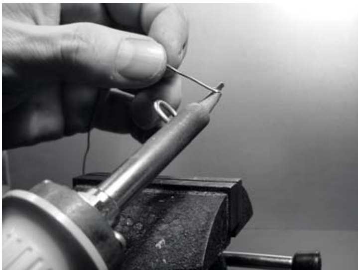
Figura 4.25: Adicione um pouco de solda ao final do fio, estanhando-o antes de soldá-lo.
