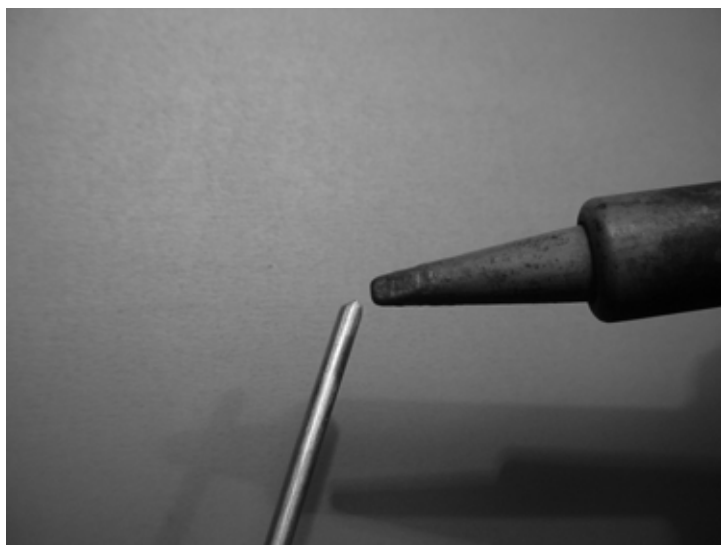
Figura 4.37: Estanche a extremidade do fio antes de soldá-lo.
