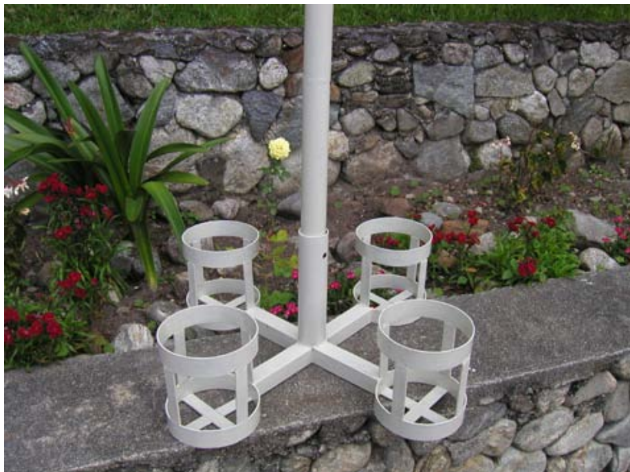
Figura 8.5: Esta base metálica pode ser fixada com sacos de areia, pedras ou garrafas de água para a estabilidade da plataforma, sem a necessidade de furos no telhado.
