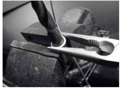
Figura 4.17: Curve o fio ao redor da broca para fazer uma espira.
