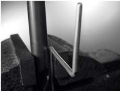
Figura 4.17: Curve o fio ao redor da broca para fazer uma espira.
