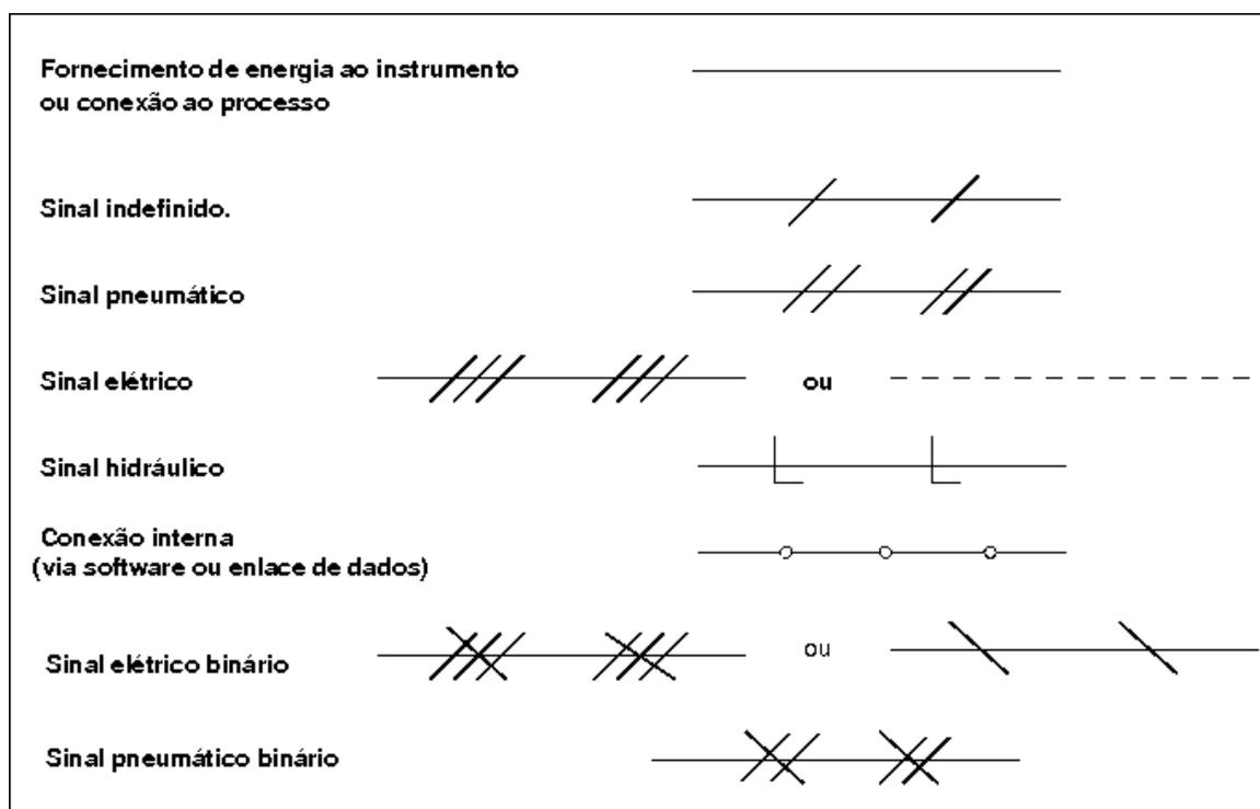
Os traços de conexão entre instrumentos dependem do tipo de sinal que os interligam no chão de fábrica, isto é, no campo (*field*).
