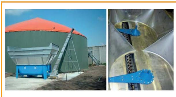
Figura 3.6: Reservatório de alimentação com desagregador [Konrad Pumpe GmbH]
