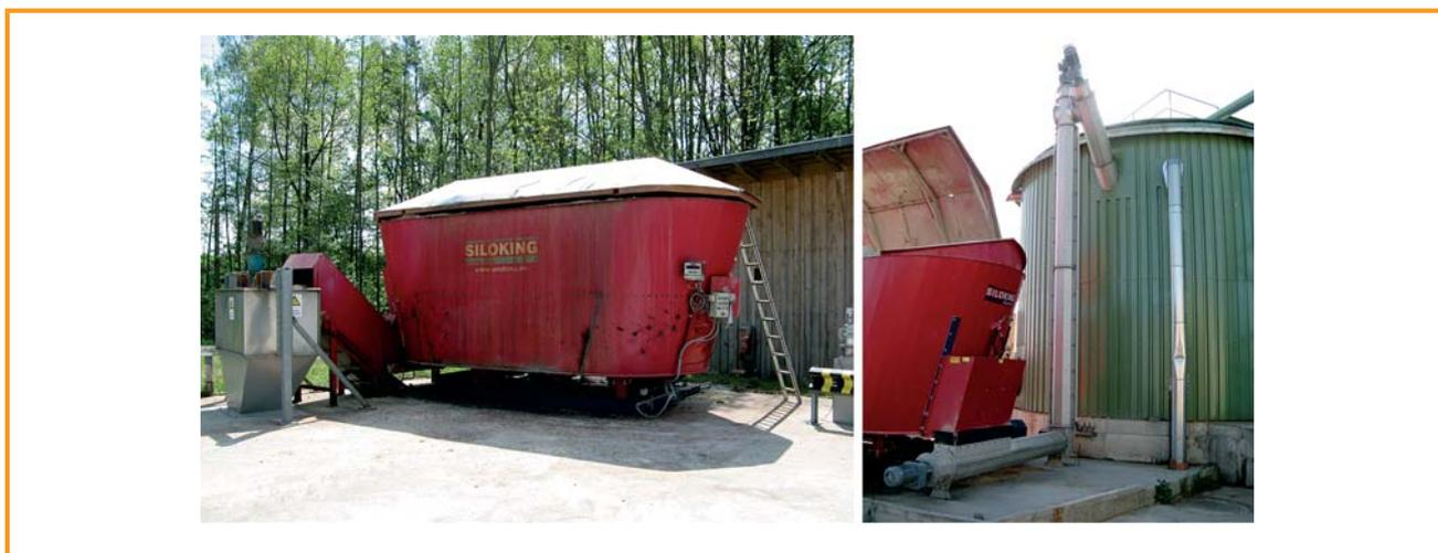
Figura 3.19: Carregamento de biomassa empilhável com transportador helicoidal [DBFZ]
