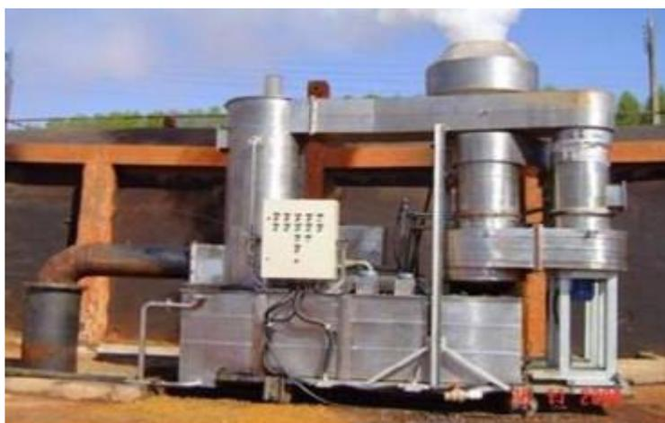
Figura 20. Recuperação dos gases condensáveis
