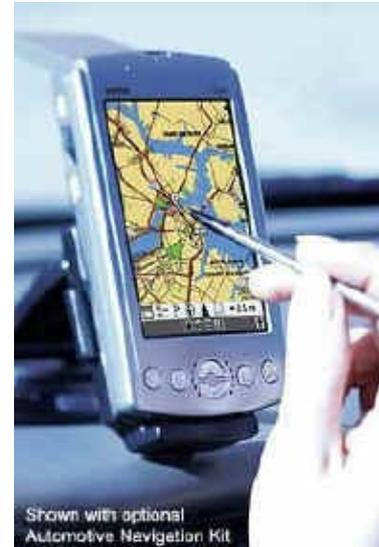
O **PDA** (Personal Digital Assistants) ou **Handheld** ou **PalmTop** ou **Pocket PC** é um computador de dimensões reduzidas, dotado de grande capacidade computacional, muito comum na década de 90, foi substituído pelos smartphones e tablets.
