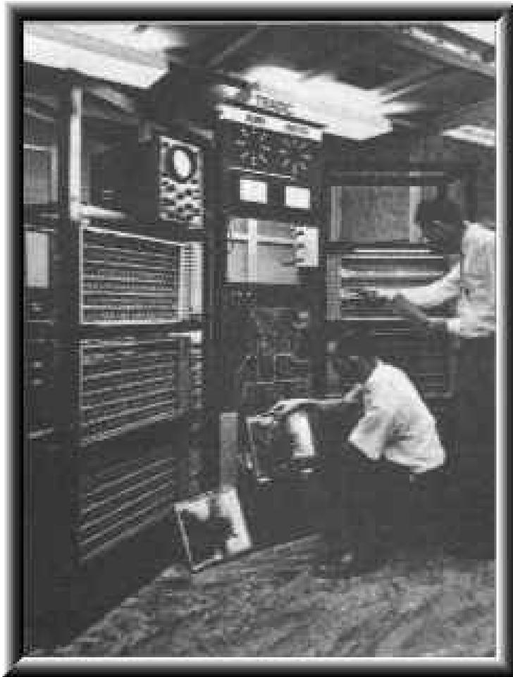
Conclui-se em 1955, o primeiro computador transistorizado, feito pela Bell Laboratories: o **TRADIC**, o qual possuía 800 transistores, sendo cada um em seu próprio recipiente.
