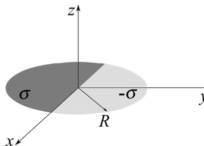
Figura 2: Disco de raio  $R$  com densidades  $\sigma$  e  $-\sigma$  de carga.
