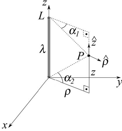
Figura 3: Fio finito carregado com densidade linear  $\lambda$  de comprimento  $L$ .
