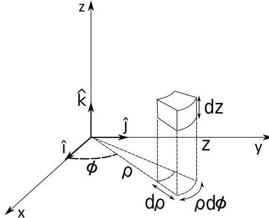
Figura 3: Sistema de coordenadas cilíndricas.
