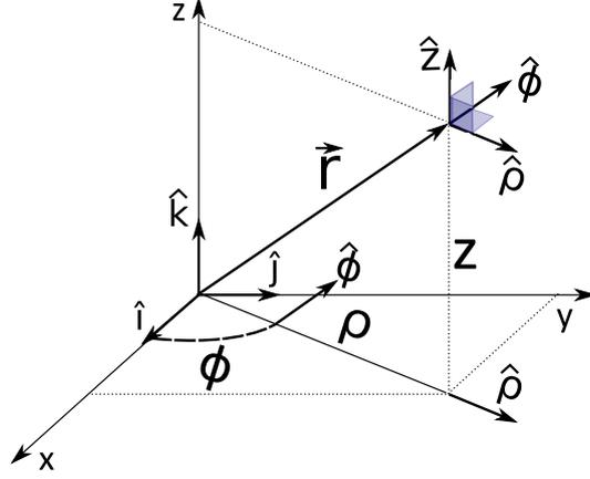
Figura 2: Sistema de coordenadas cilíndricas.
