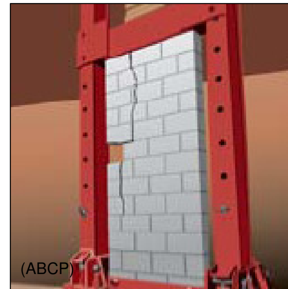
Ensaio de compressão de parede
