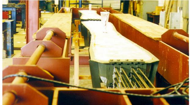
b) estrutura formada por perfis metálicos para estiramento da armadura de protensão e duas peças em linha já concretadas;
