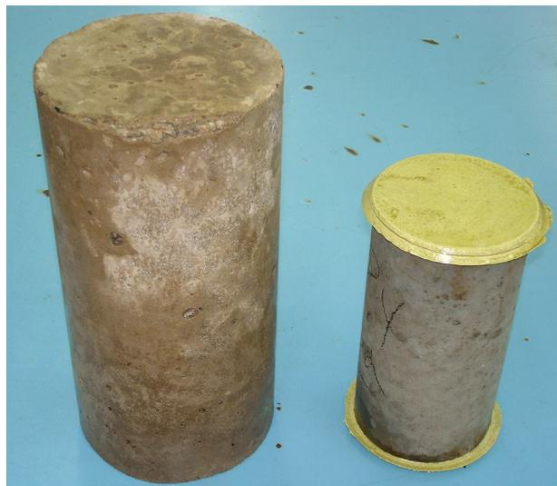
Figura 66 – Corpos-de-prova cilíndricos 15 x 30 cm e 10 x 20 cm para determinação da resistência à compressão de concretos (Cortesia de Obede B. Faria).
