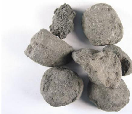
Figura 7 - Clínquer para fabricação de cimento.
