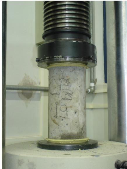
*Figura 67 – Corpo-de-prova cilíndrico em ensaio para determinação da resistência à compressão do concreto (Cortesia de Obede B. Faria).*
