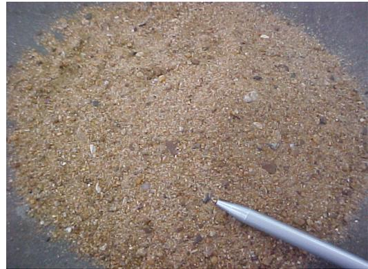
Figura 2 – Agregado miúdo (areia).
