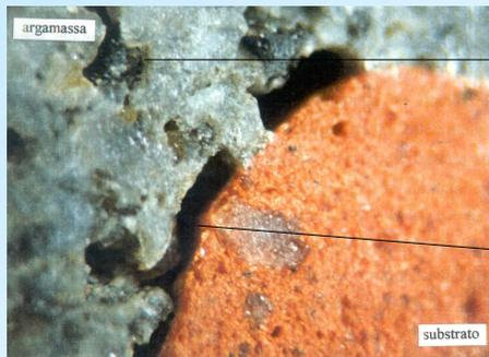
Vazios na argamassa: diminui a resistência mecânica
