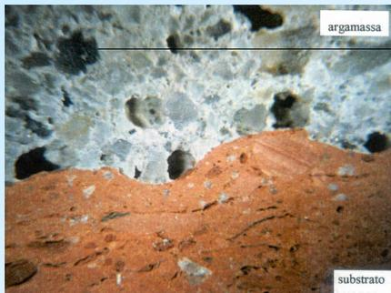
→ Vazios na argamassa: diminui a resistência mecânica
