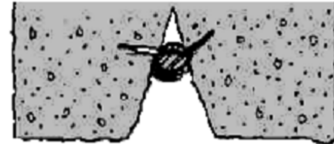
b) Fissuração devida às forças de expansão dos produtos da corrosão.
