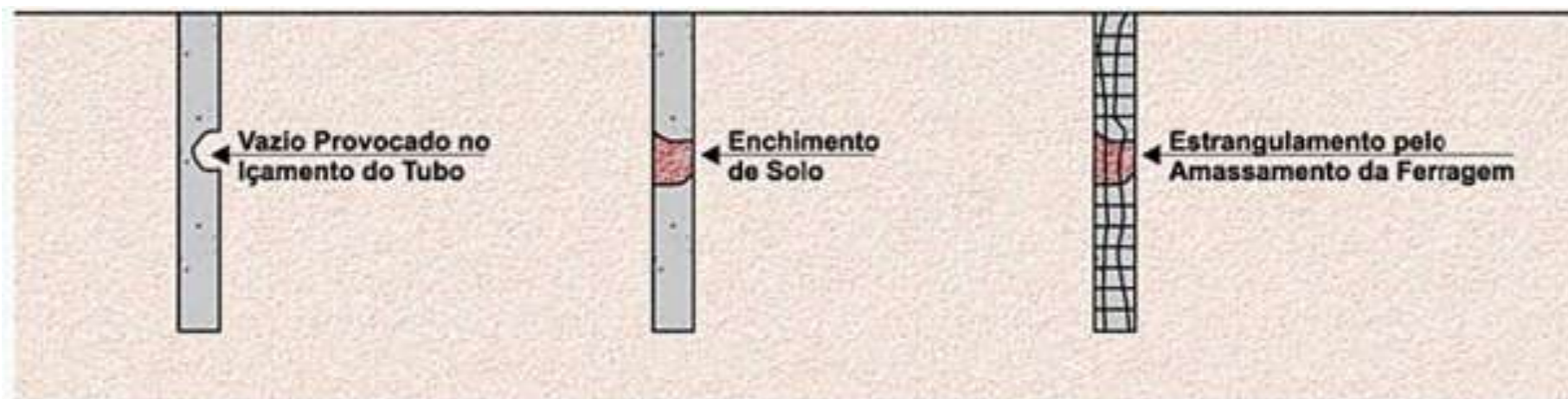
Fig. 4.6.4. Falhas em estacas moldadas no local
