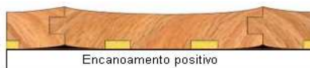
Figura 86 – Possível defeito em pisos de madeira.
