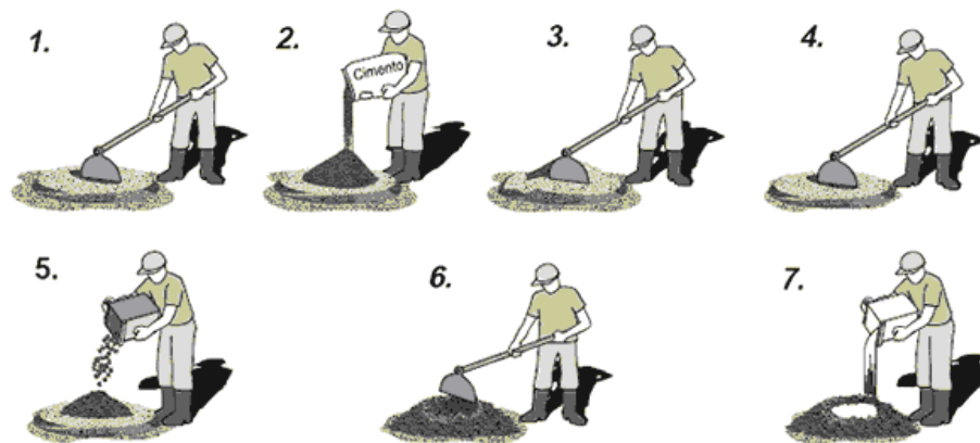
Figura 28 – Mistura manual de concreto .
